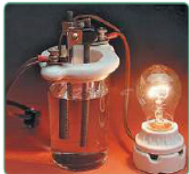
Рис. 8. Электролизёр — прибор для определения электропроводности растворов
